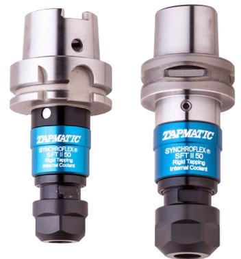
일체형 가파른 테이퍼 생크 공구를 제공 할 수도 있지만 대부분의 경우 SynchroFlex®의 짧은 길이의 SK, BT 또는 CAT 생크를 사용하는 모듈식 원통형 생크 시스템을 권장합니다.
